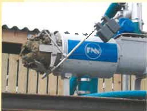
Séparateur de phase
